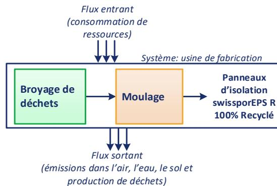
Schéma simplifié des procédés de fabrication (étapes A1 à A3)
